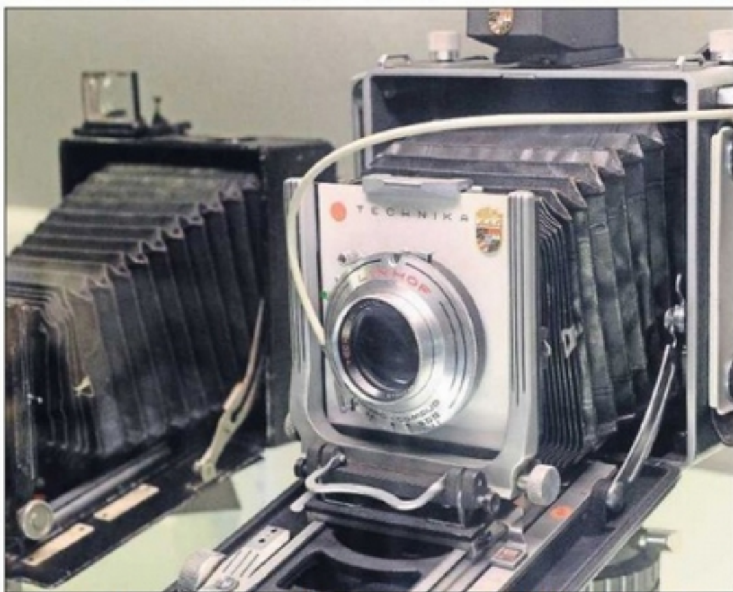
Blick in ein Regal des Fotomuseums in Deidesheim: Eine Balgenkamera vom Typ Linhof Super Technika (Baujahr 1946 bis 1958) war einst ein Apparat für professionelle Fotografen.
